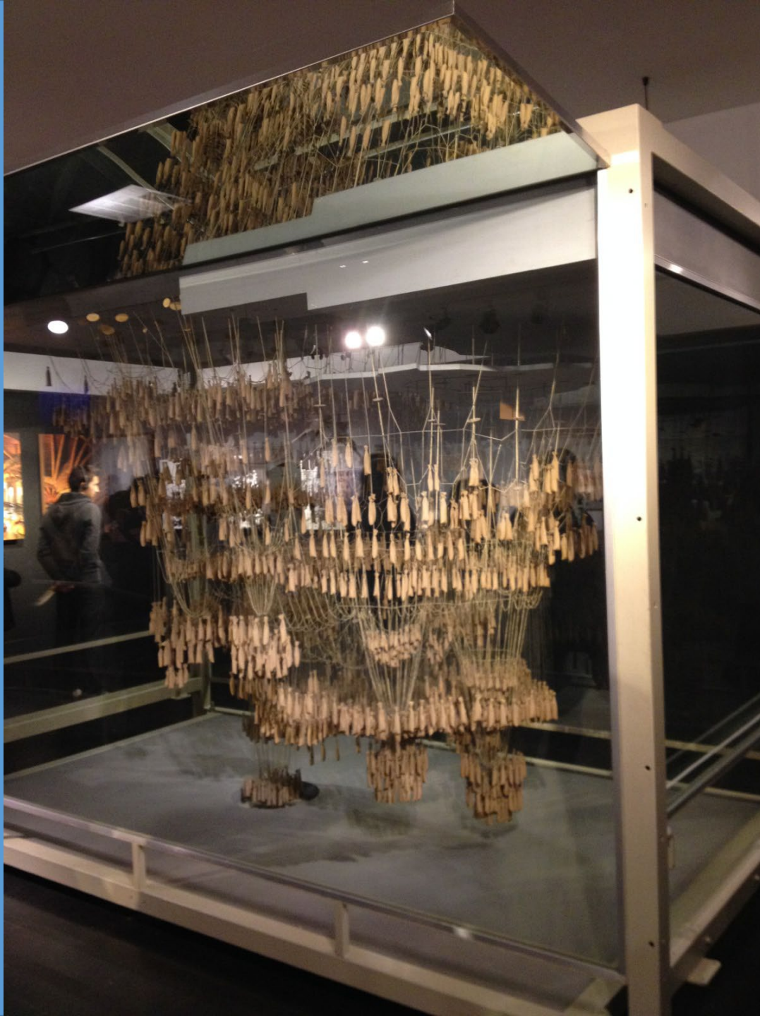
Maquette particulière inventée de la maison du Temple de la Sagrada Família Échelle 1:25 Maquette particulière inventée de la maison du Temple de la Sagrada Família Échelle 1:25 Invented hanging model of the mass of the Temple de la Sagrada Família Scale of 1:25
